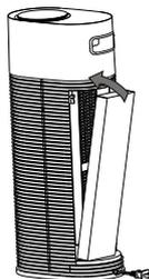
2. Instale la tapa trasera y presione la hebilla hasta que escuche un sonido para probar que la lengüeta está bloqueada.
